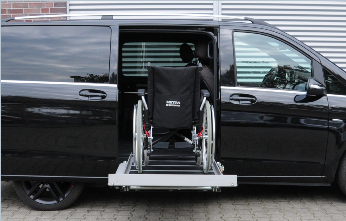
Die automatische Abrollschutzklappe und die großzügige Plattform sorgen für zusätzliche Sicherheit.
